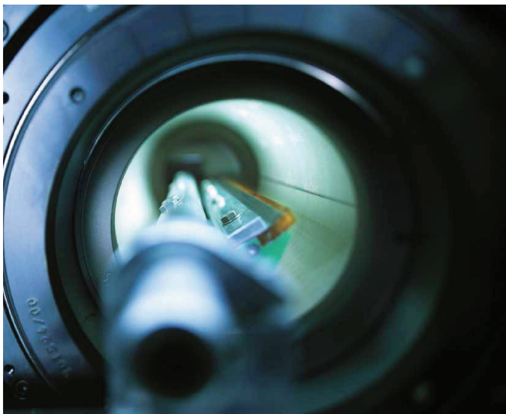
La racle est à l'intérieur du cylindre que forme l'écran.
